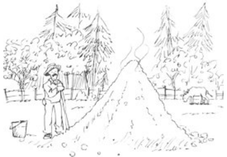
Horno de tierra: requiere mayor tiempo, esfuerzo y cantidad de madera que cualquier otro sistema cerrado (metálico o ladrillo). La quema dentro del bosque, conlleva alto riesgo de incendios forestales.
